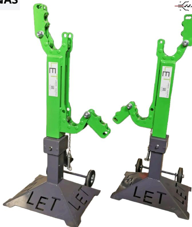
**Gatos alzabobinas** de cremallera, con accionamiento por manivela, base y estructura de acero, rodillos montados sobre cojinetes para una mejor rotación de la bobina, capacidad hasta 5 TN, doble nivel de subida.
