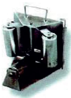
Rodillo en acero para tendido en curva de cables subterráneos. Montado sobre cojinetes de bolas y bastidor en acero galvanizado. Rodillos verticales oscilantes para el tendido en curva de elementos múltiples.
