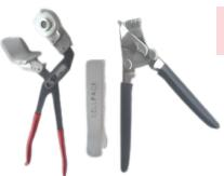
Herramienta de corte longitudinal de cubierta para cables con pantalla de aluminio tipo RH5Z1.
