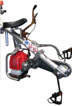
Freno de estacionamiento y dispositivo cuenta metros
